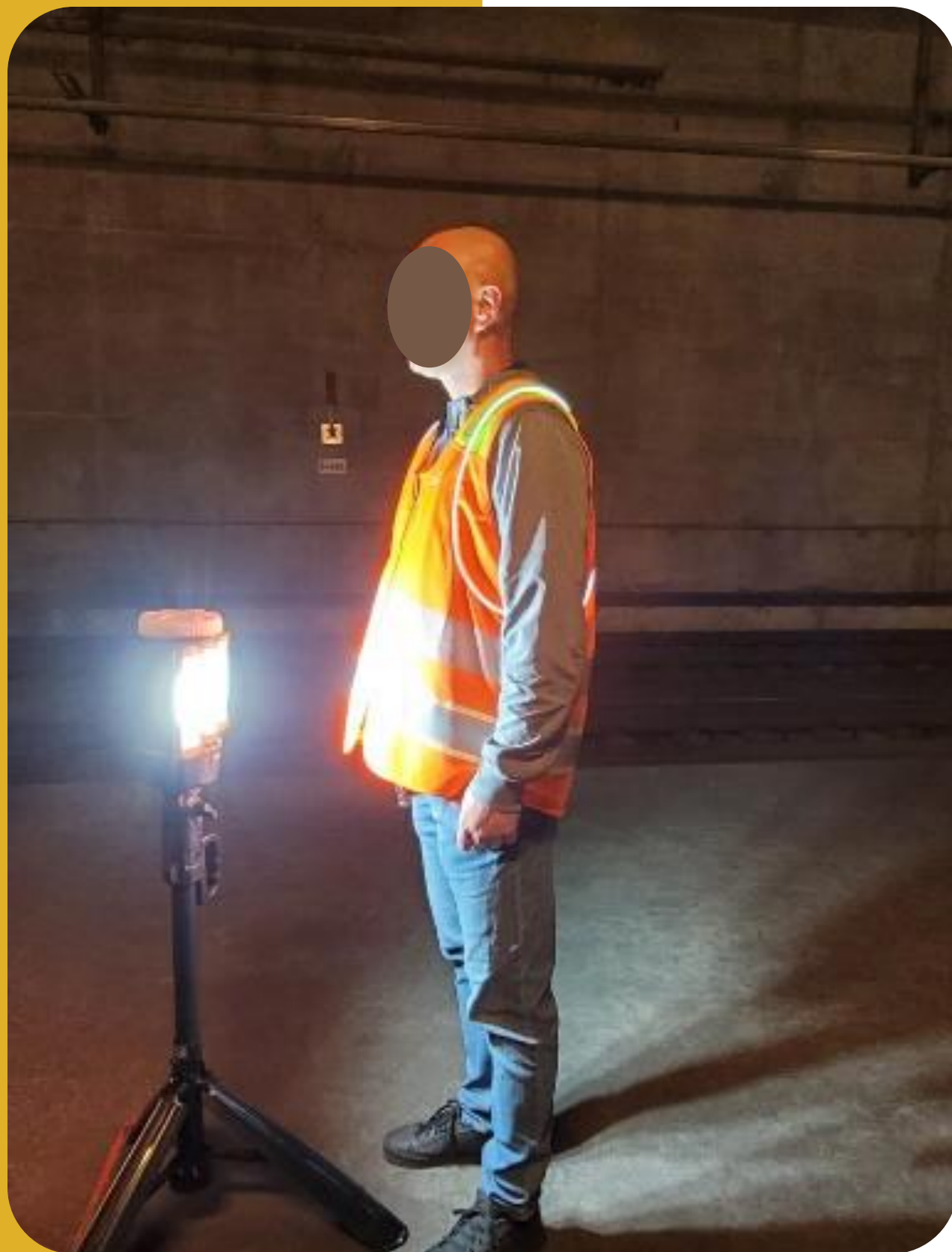
Etap naświetlania taśm fosforescencyjnych w kamizelce
