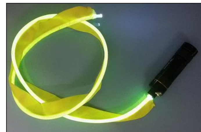
Przykład światłowodów typu SEPOF (producent: SCILIF, Czechy)
